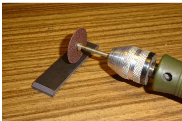
Meulage de l'encoche sur le dételeur
